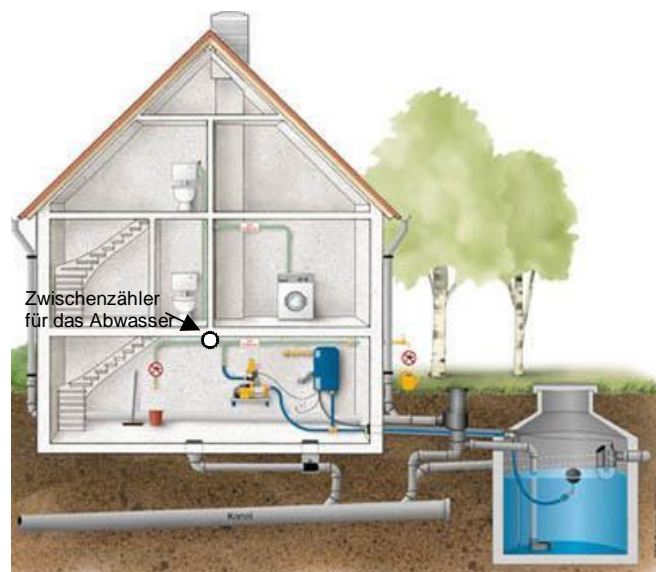
Skizze: Einbauort des Zwischenzählers vor den Verbrauchern
